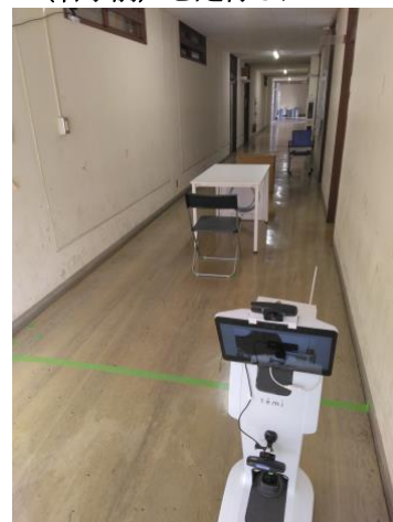
図 1 実験に使用したテレプレゼンスロボット “Temi” (右手前) と走行したコース (左奥)
