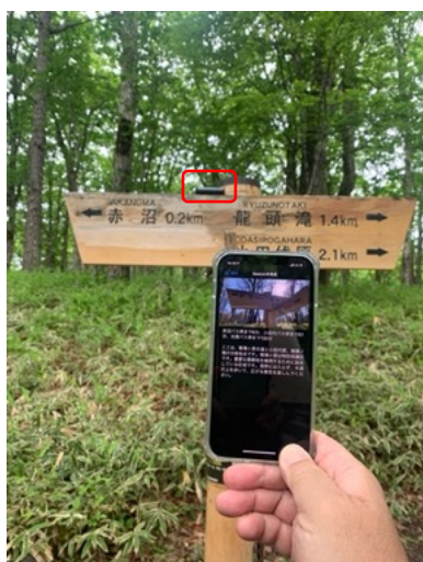
図 3 道標に設置した BLE Beacon 及びアプリケーション画面
