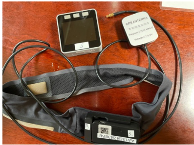
図 8 脳波センサー付きバンダナ及び GPS 装置
