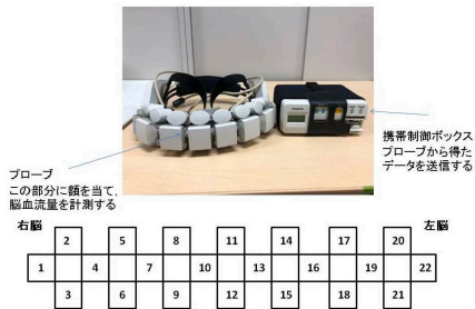
図 2 光トポグラフィ装置のプロープ配置.
