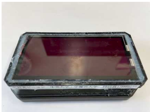
図 1-1 新しい BLE ビーコンの外観 (サイズ : 125 x 80 x 25)
