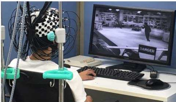
図1. 近赤外分光装置による脳活動計測の様子
