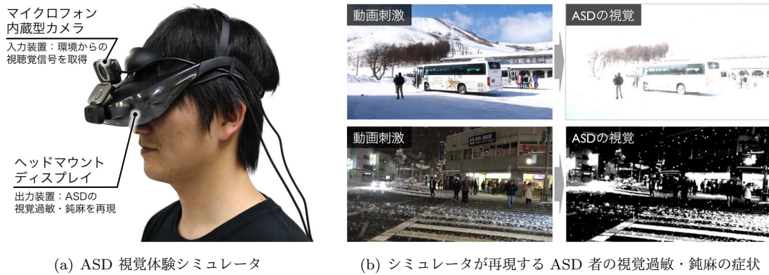
図5 ASD者の視覚過敏・鈍麻を再現するヘッドマウントディスプレイ型ASD視覚体験シミュレータ
