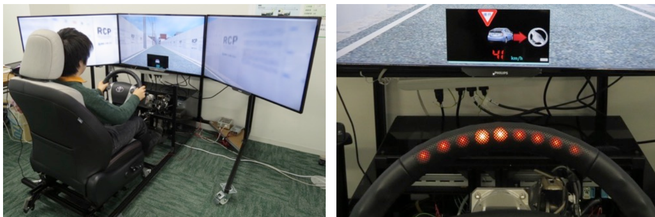
図 1 実験に使用したドライビングシミュレータ。左図は装置の外観を、右図はステアリングと速度計に表示される情報提示の一例を示す。警告時には各視覚刺激は緑色で表示されるが、介入時には赤色で表示され、音や振動パターンも変化する。ステアリング LED は左右方向に流れるように遷移することでドライバの操作を誘導する。
