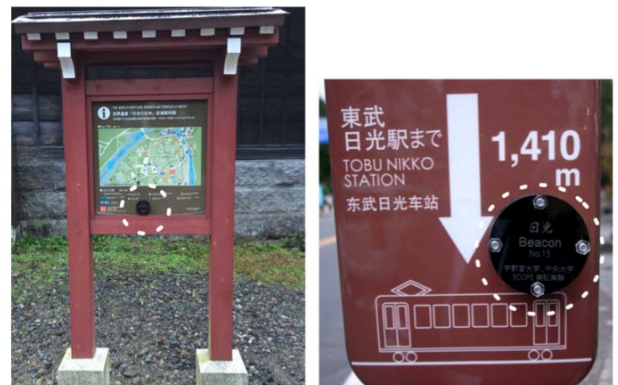
図14 ビーコン設置状況
