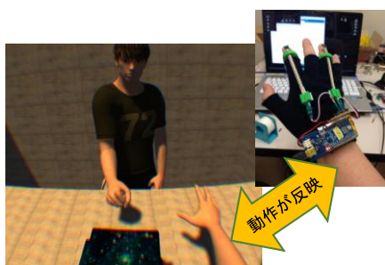
図 1 自作モーションセンサーを用いた CG モデルへの動作の反映
