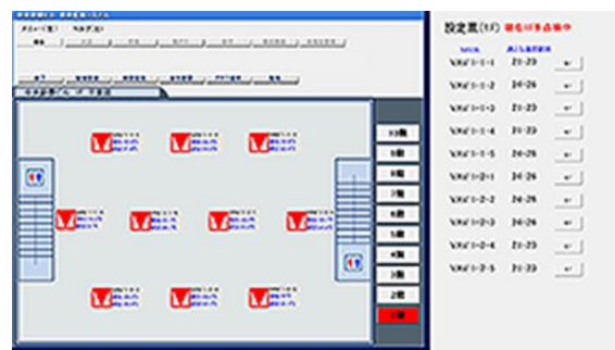
図2 中央監視装置のシミュレータ
