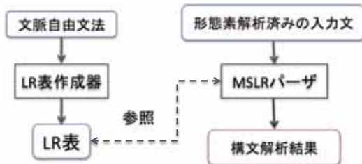
図1 MSLRパーザを用いた構文解析の流れ
