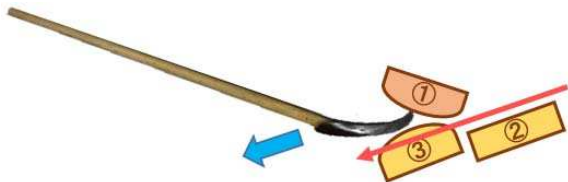
図 11-3 鳶口を引きながら材木②③を超える
