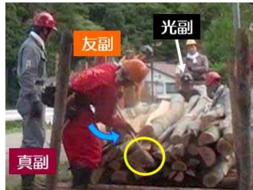
図 12-1 掛矢による打ち込み
